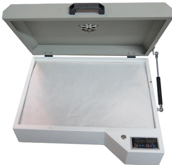
El horno para FTS con formato A3+ esta diseñado para proporcionar una temperatura homogénea en todo el área para un correcto curado del adhesivo FTS. El horno FTS cuenta con un panel de control que permite configurar la temperatura (°c) y tiempo (Seg) para realizar las aplicaciones requeridas.
